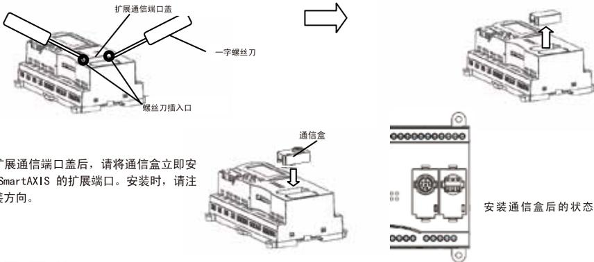
拆下扩展通信端口盖后，请将通信盒立即安装到 SmartAXIS 的扩展端口。安装时，请注意安装方向。
