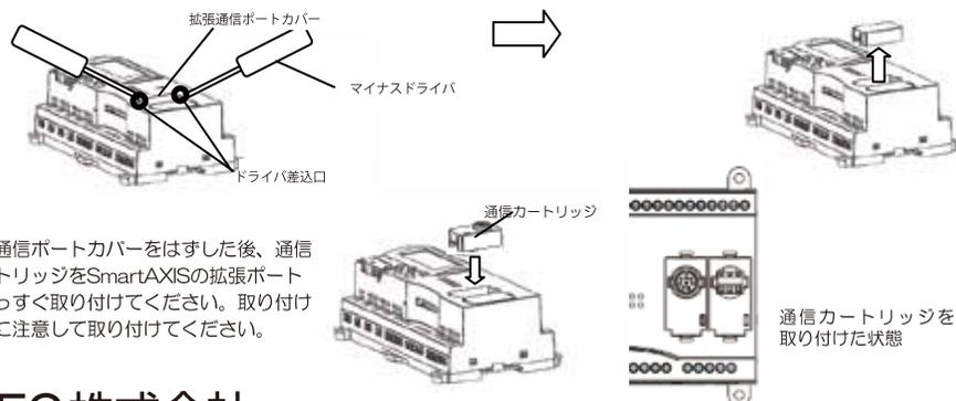
拡張通信ポートカバーをはずした後、通信カートリッジをSmartAXISの拡張ポートにまっすぐ取り付けてください。取り付け方向に注意して取り付けてください。
