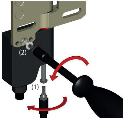
1.1 Die Schrauben (1) und (2) müssen mit dem mitgelieferten Spezialbit gelöst und bei Seite gelegt werden. Diese Schrauben werden im weiteren Ablauf des Umsetzens des Schalters an dem SHS3 wieder benötigt!
