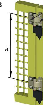
**1.1** Scharniere mit der 1. Scharnierhälfte auf einem ebenen Untergrund ausrichten und leicht mit den Befestigungsschrauben fixieren.
