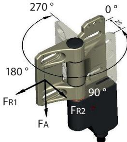
Der SHS3 hat einen **Schwenkwinkel** von 0° – 270°. In diesem Bereich ist auch der Schaltpunkt frei wählbar.
