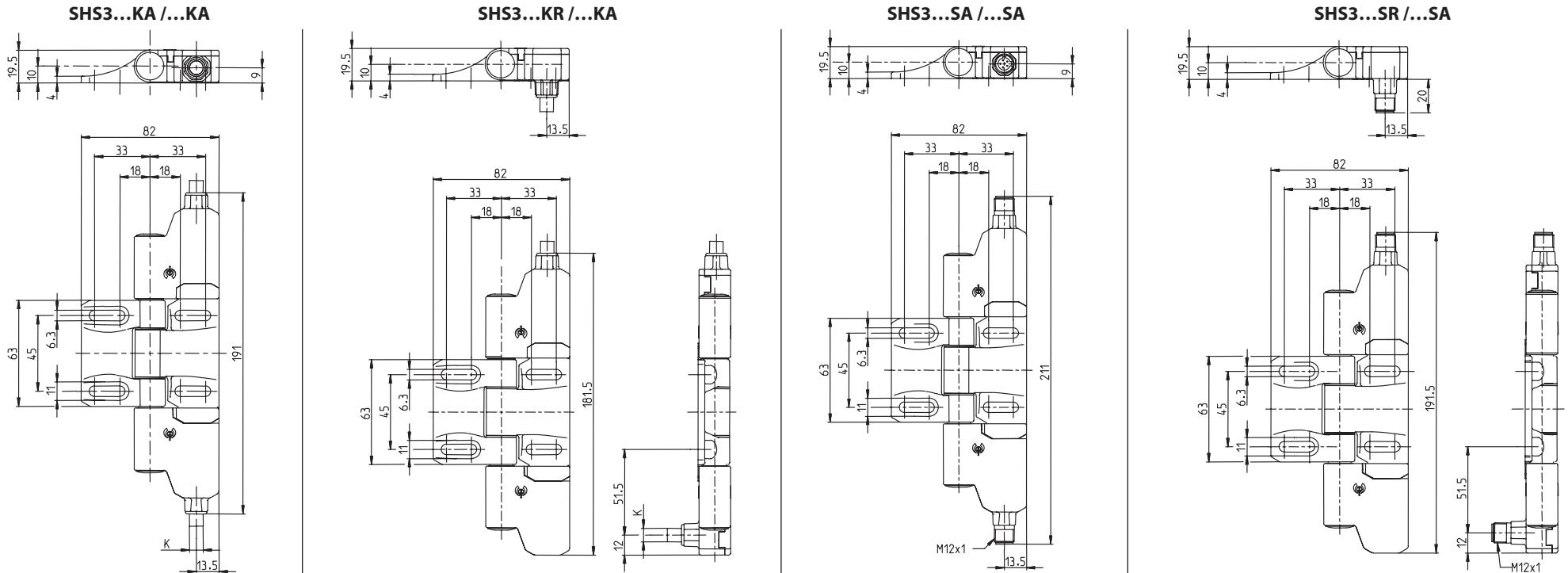
Bohrung in Rahmen vorsehen min. Ø 16,5 /
