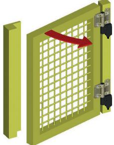
Nach der Installation und der ggf. erfolgten Feinjustage des Schaltpunktes, muss das System auf Funktion überprüft werden. Die Sicherheitskontakte in dem SHS3 müssen, wenn die Tür mehr als 3° ( $\pm 1,5^\circ$ ) geöffnet wird, öffnen.
