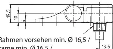
Bohrung in Rahmen vorsehen min. Ø 16,5 /
